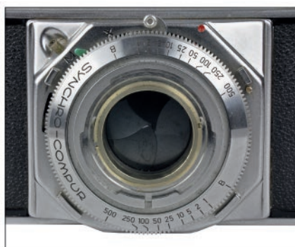
Otturatore centrale nel corpo di una Voigtlander Prominent.
