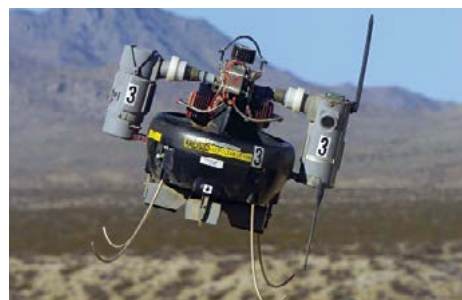
Sopra: RQ-16A T-Hawk del 2006, un drone da ricognizione dell'esercito USA ripiegabile in uno zaino e manovrabile da una sola persona.
